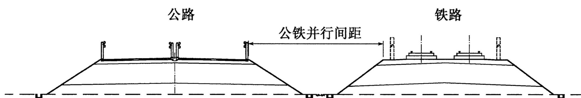
图 1 公铁路堤并行示例
