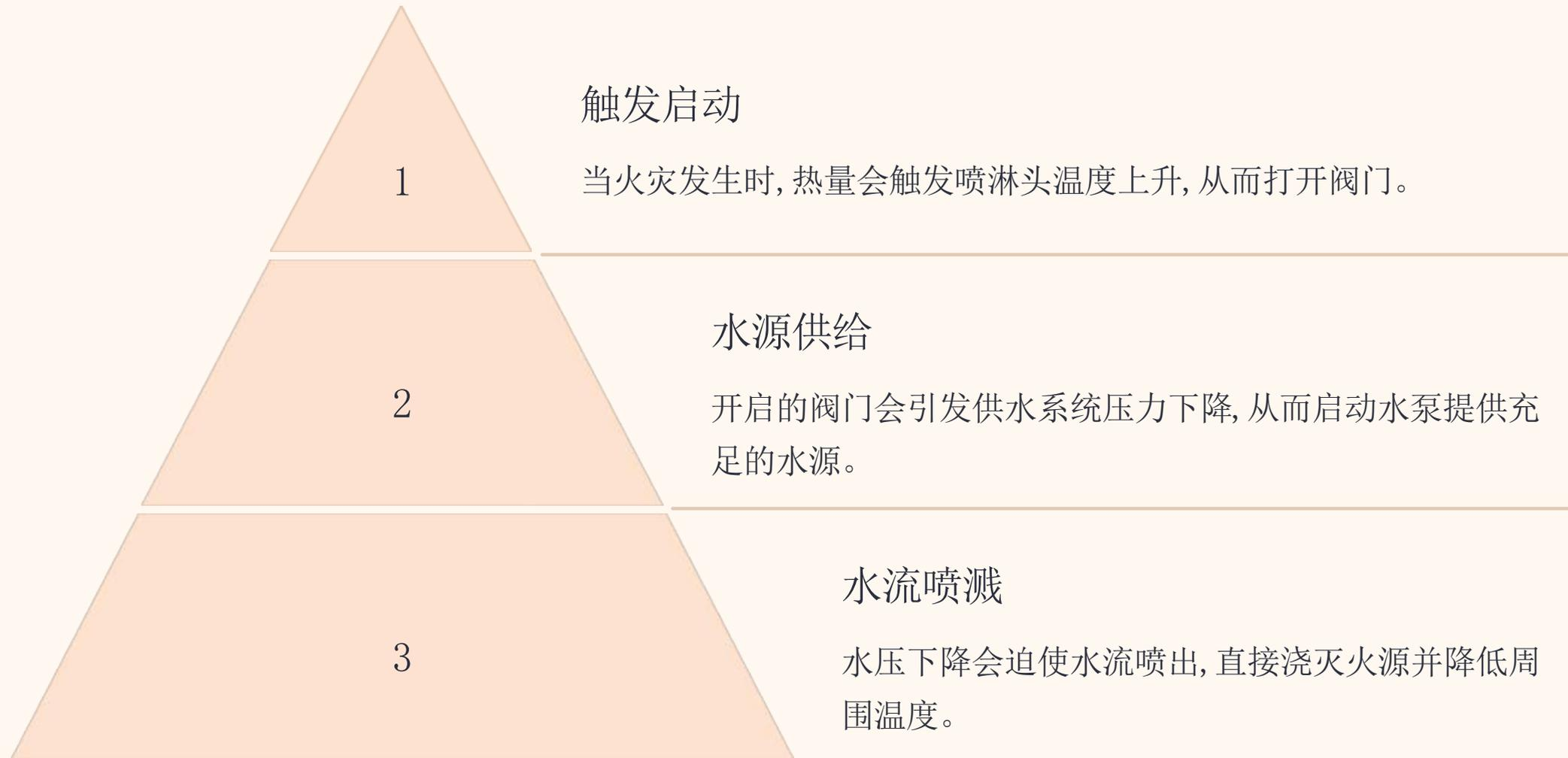
喷水灭火系统采用“感知-反应”的工作原理, 在火灾发生时能自动启动, 迅速将水流喷出进行灭火。该系统主要包括喷淋头、管路、水源及控制装置等关键部件, 通过温度感应、压力变化等触发水流喷出, 从而有效控制火灾蔓延。
