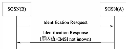
图 4 “MS 向新 SGSN 发起 GPRS 附着——在原 SGSN 中 IMSI 未知”信令流程
