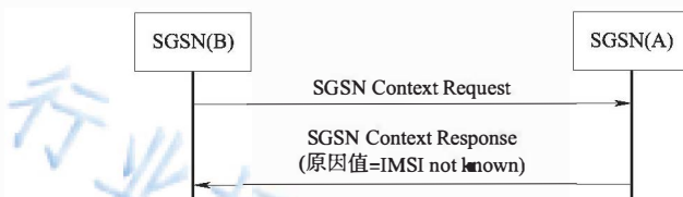
图 6 “IMSI 未知时的 SGSN 间路由区更新”信令流程
