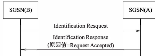
图 3 “MS 向新 SGSN 发起 GPRS 附着——原 SGSN 中有用户数据”信令流程
