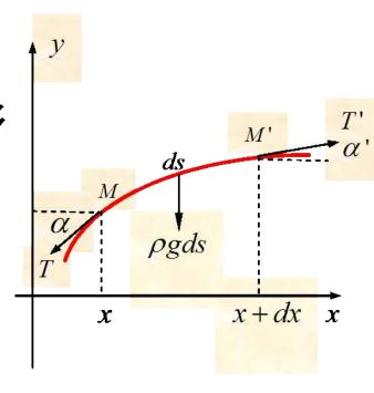
由假设3,弦线张力T(x)总是沿着弦在x处的切线方向.由于弦只在垂直x轴的方向进行横振动,因此可以把弦线的张力T(x)在x轴的方向的分量看成常数T。对于图中选取的弦段而言,张力在x轴的垂直方向上的合力为:
