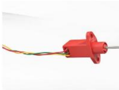
图 7.2 LPS 位移传感器
