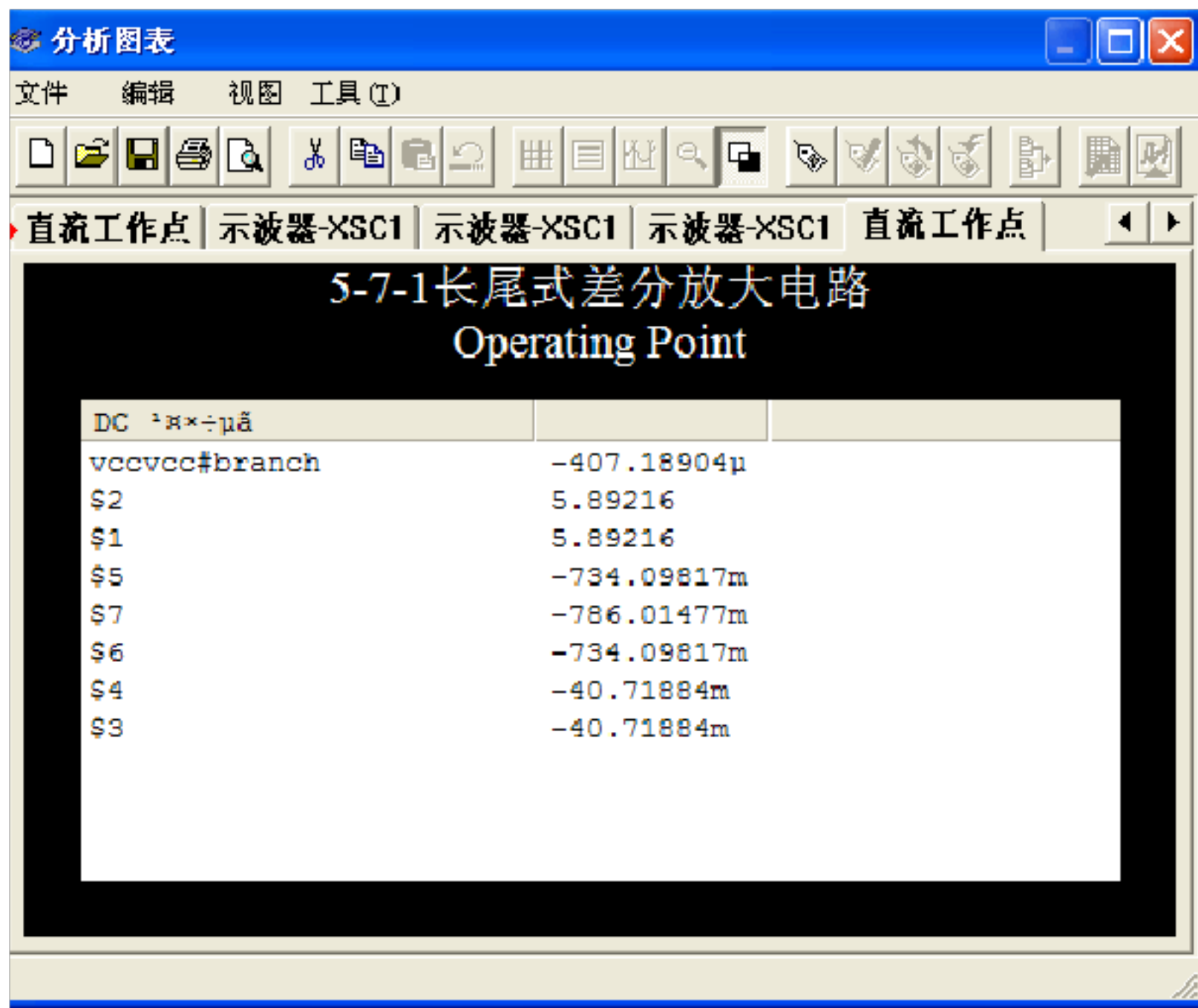
图十三 长尾式差分放大电路直流工作点分析图
