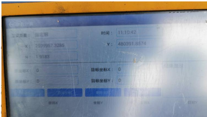
图 5.2.3-3 K16+787 现场验证，距基站直线距离 12.8 公里，精度，信号良好
