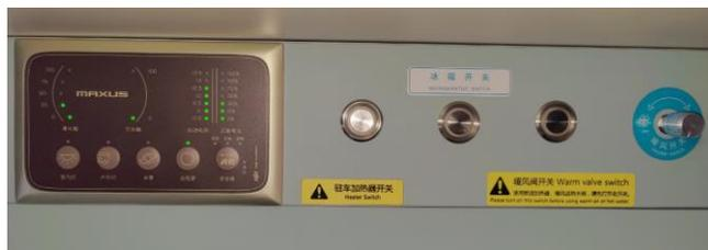
家居控制模块为房车电器设备的驱动及控制模块，安装位置以实车为准，家居控制模块示例如下图（注：后床铺右侧柜门内）。
