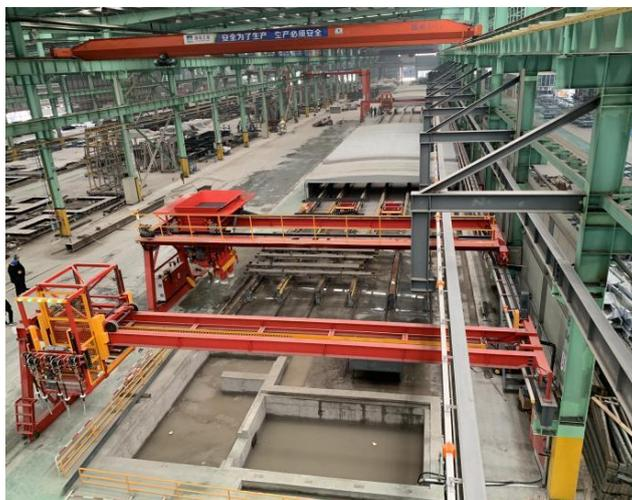
图 4-6：PEC 自动浇筑生产线
