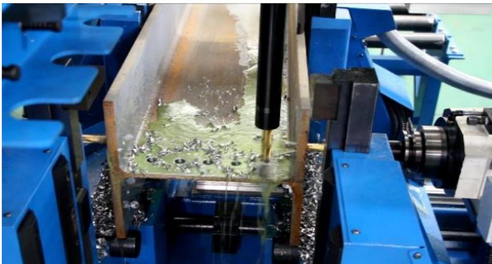
图 5-11：高速三维钻床
