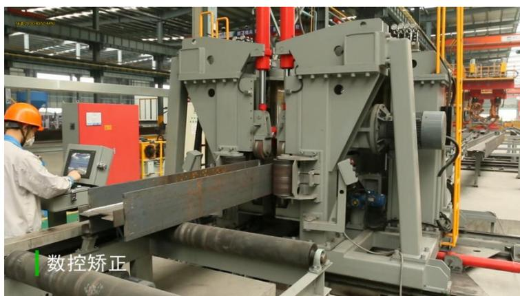
图 5-9：H 型钢自动矫正设备
