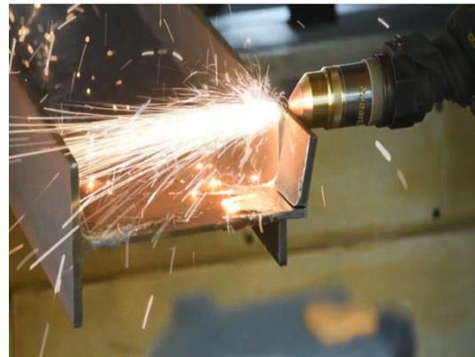
图 5-1: H 型钢三维等离子切割      图 5-2: H 型钢三维等离子切割
