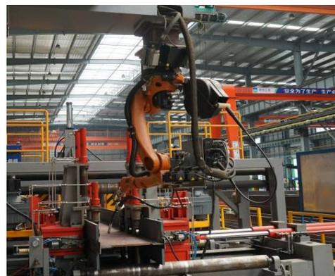
图 5-5：机器人自动点焊
