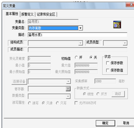
图 3.12 备用泵 1 变量属性设置
