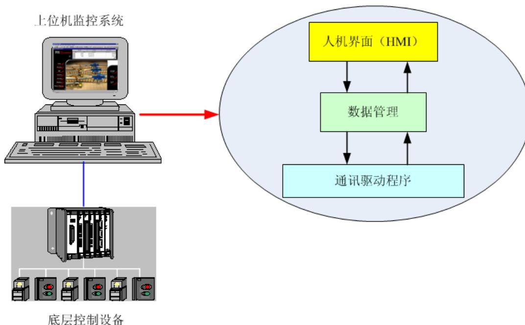
A、目前高频电源改造项目监控系统可以分成两层：上位机监控系统和底层控制设备（相对应我们的工程就是高频电源）两层。上位机监控系统主要功能是实现底层控制设备数据采集，数据管理（过程监视，监控，报警，报表，数据存档等等）、人机界面（现场信息实时监控、人工干预现场运行）。
