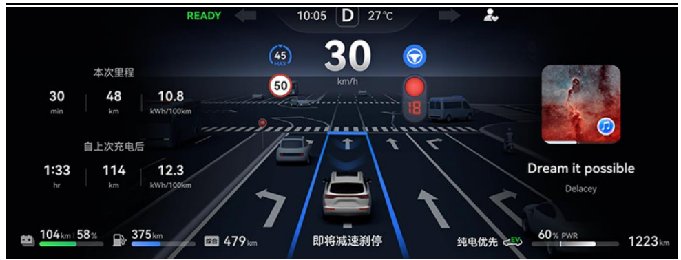
图表8:车道巡航辅助功能识别信号灯并自动减速
