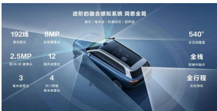
图表2:HUAWEI ADS 2.0 智能驾驶系统
