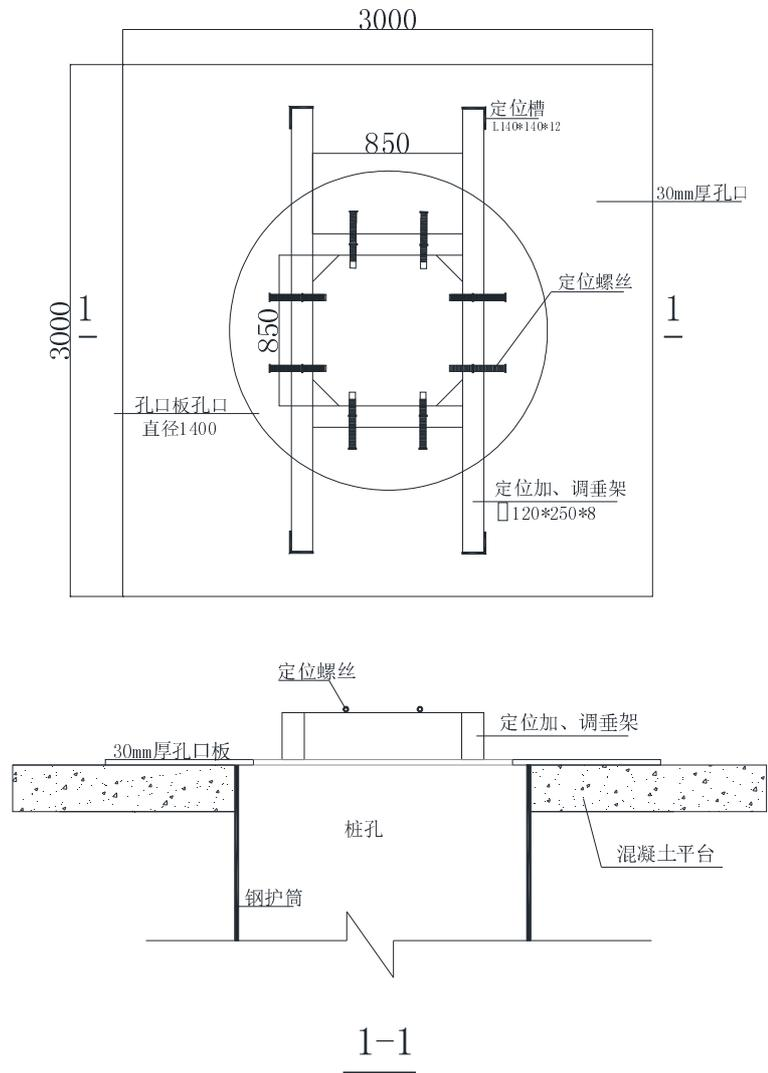
图 5.2.1-1 地面调垂架施工示意图
