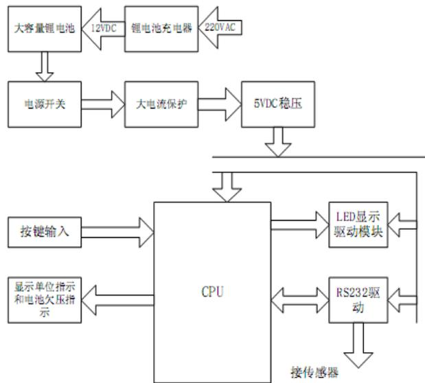
图 5.2.4-5 激光倾斜仪原理框图
