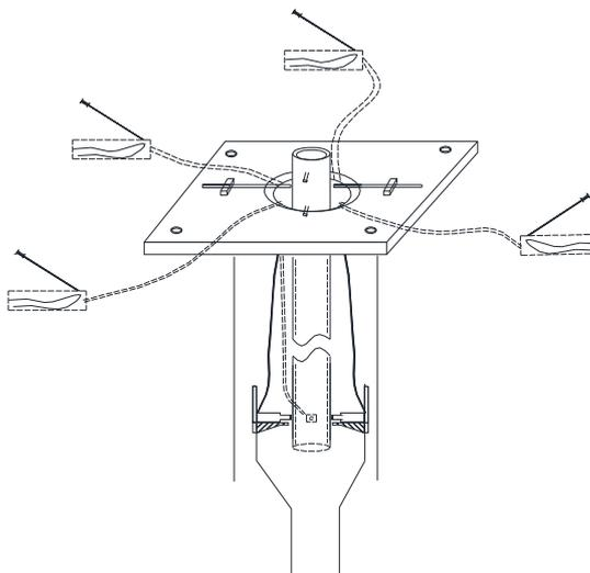
图 5.2.2 调整装置安装示意图
