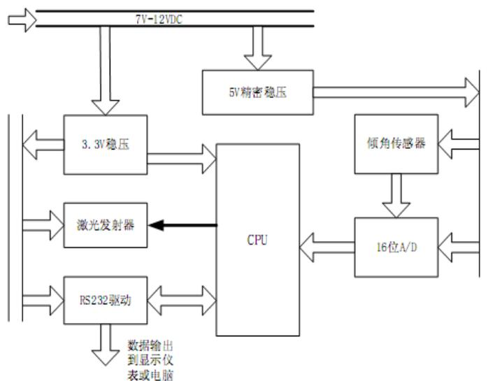
图 5.2.4-6 仪表箱显示接收控制原理框图
