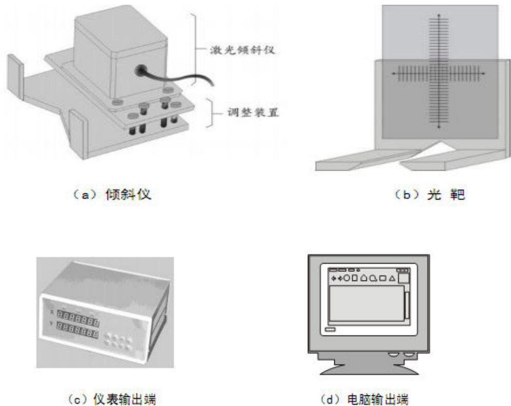
图 5.2.4-2 激光倾斜仪系统结构示意图
