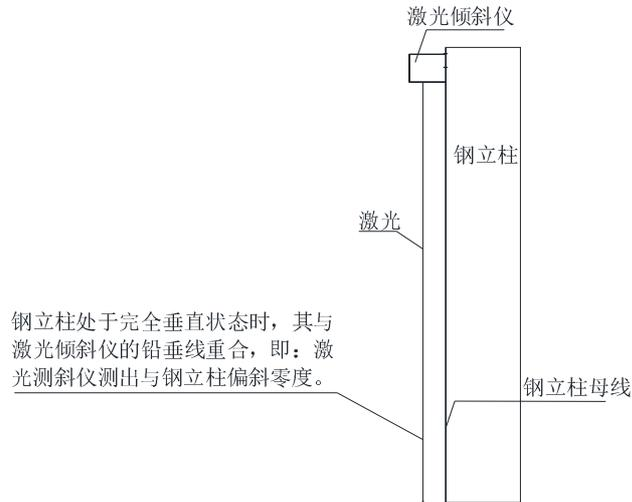
图 5.2.5-1 钢立柱完全垂直状态
