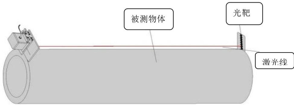
图 5.2.4-3 激光倾斜仪安装示意图
