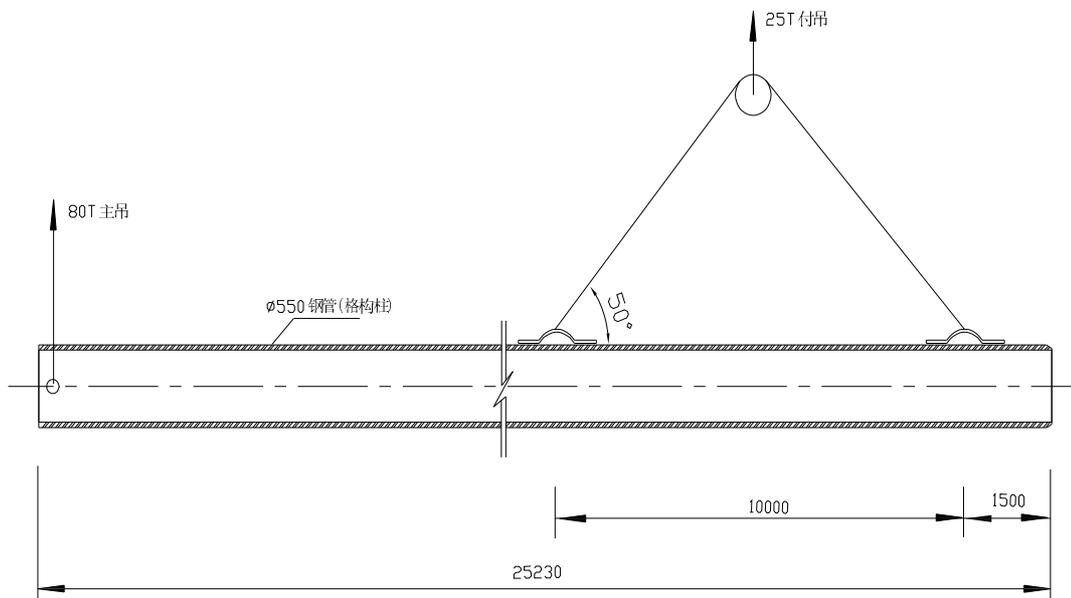
图 5.2.4-1 钢管（格构）柱起吊示意图
