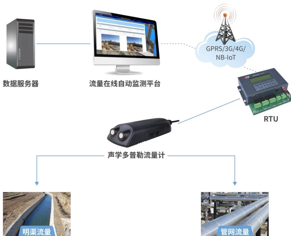
图 3-1 系统逻辑架构图
