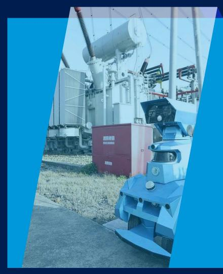
目前, 变电站巡检机器人已在国内外得到广泛应用, 主要用于高压、超高压和特 高压变电站的设备巡检。
