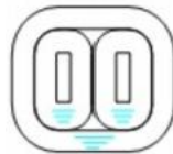
三框三柱式非晶合金铁心结构图
