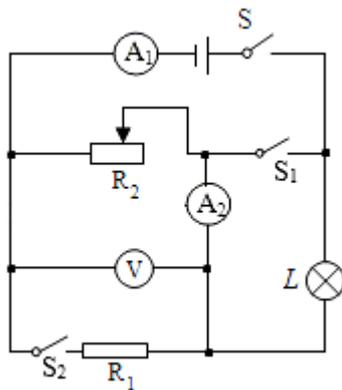
**【解答】**解：（1）由图可知， $R_a$  与  $R_1$  并联接入电路，电流表  $A_2$  测通过  $R_1$  的电流，电流表  $A_1$  测干路电流；
