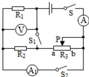
**【解答】**解：当只闭合开关 S，滑片 P 滑至 a 端时，电阻  $R_1$  和  $R_2$  串联接入电路，电压表测电阻  $R_1$  的电压，电流表测通过电路的电流，
