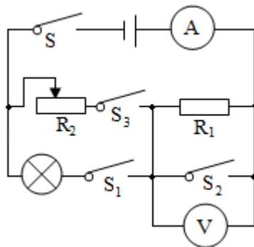
【解答】解：（1）只闭合开关 S、S<sub>3</sub>，滑片置于最左端时，滑动变阻器和 R<sub>1</sub> 串联，电压表测量 R<sub>1</sub> 两端的电压，电流表测电路中的电流，
