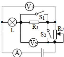
**【解答】**解：（1）闭合开关  $S_1$ 、断开  $S_2$ ，滑动变阻器的滑片  $P$  移到阻值最大值处时， $L$  与变阻器的最大电阻串联，电流表测电路的电流，电流表的示数为  $I_1$ ；
