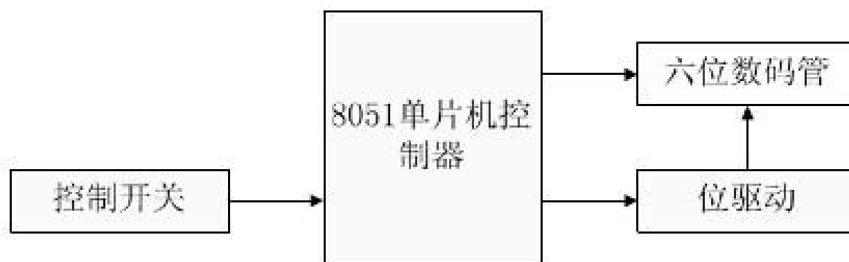
图 数字秒表硬件电路基本原理图
