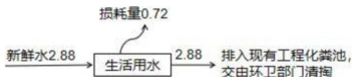
图1 本项目水平衡图（单位：m<sup>3</sup>/d）
