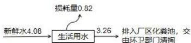
图2 本项目建成后全厂水平衡图（单位：m<sup>3</sup>/d）
