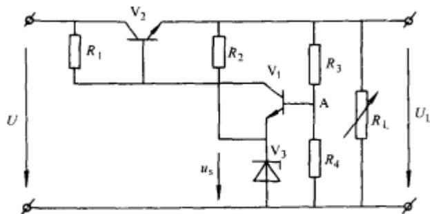
图 1-17 晶体管稳压电源电路
