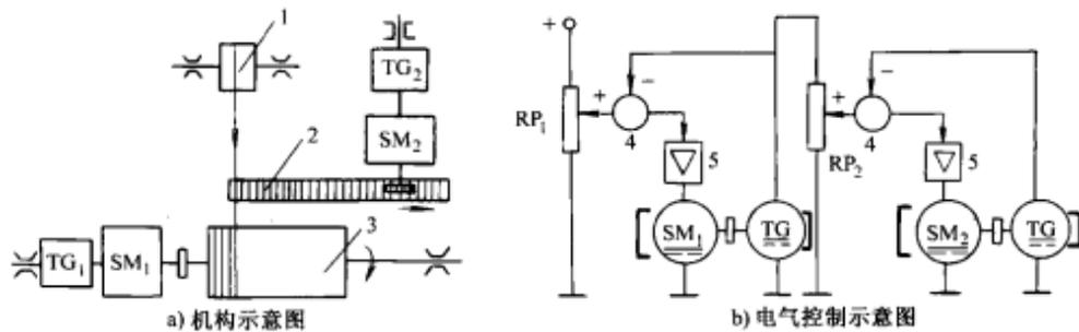
图 1-19 自动绕线机速度控制系统
