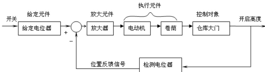
图 (1-2) 仓库大门控制系统组成框图
