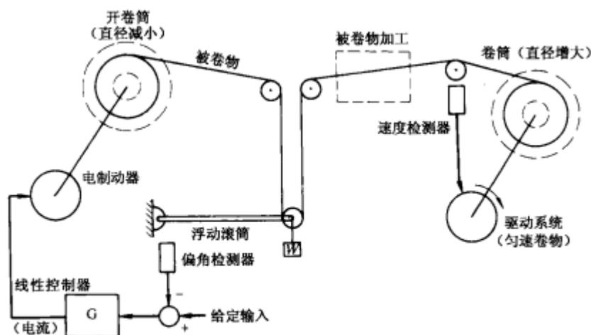
图 1-20 卷绕加工的恒张力控制系统
