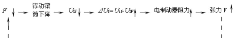
直至  $F=W/2$ ，浮动滚筒不再移动，电制动器阻力不再变化为止
