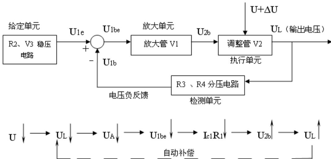
**图 (1-1) 稳压电源电路的框图及自动调节过程**
