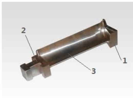
图 3 汽轮机动叶
