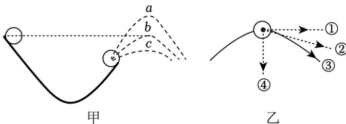
**【解答】**解：图甲：小球沿轨道运动过程中，由于轨道粗糙，一部分机械能转化为内，机械能减小，到达轨道右侧最高点要低于起始点，所以不可能沿a和b轨迹运动，可能沿c轨迹运动；
