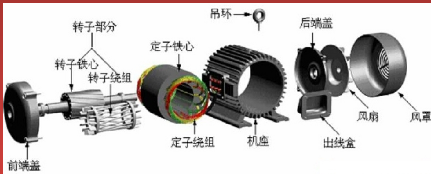
三相笼型异步电机的主要结构
