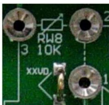
图2.17 RW8电位器示意图
