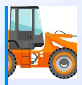
动臂与转斗油缸、举 升油缸等连接,实现 装载机的举升和卸载 功能。
