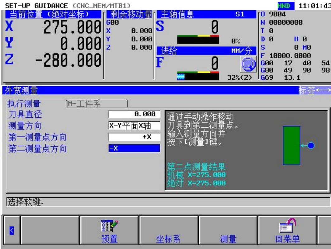
7、按→键，移至 M-工件系，输入工件坐标系号，如 G54 则输入 54。工件坐标值输入 0，按设定键完成。
