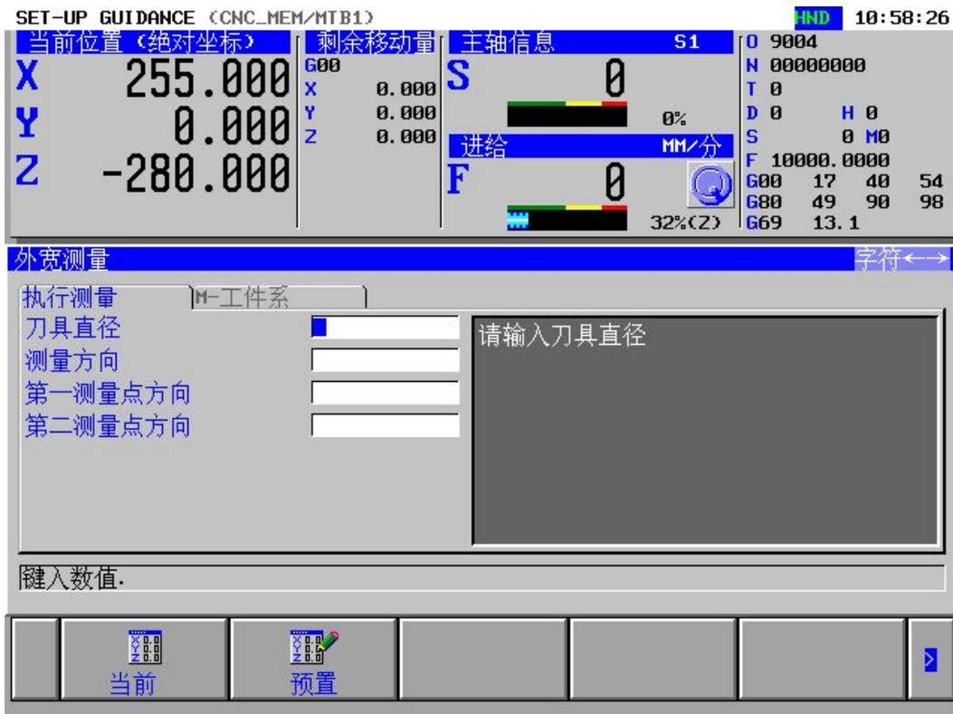
3、输入刀具直径，下移光标，选择测量方向 X。
