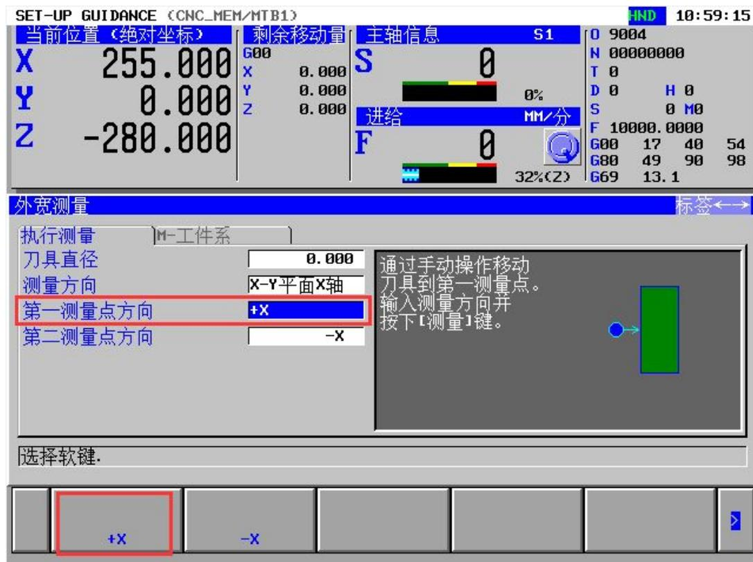
5、手轮移动，使刀具刚好接触到工件的+X 边，先按下右侧“>”，再按下测量键记录此时的坐标
