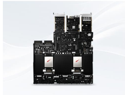
图表14: 鲲鹏服务器主板 (型号: S920X00)
