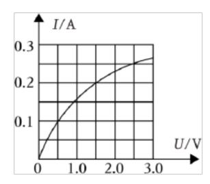
20. (2023•广安)如图所示为灯泡L和定值电阻R的U-I图象,若将L和R并联在电源电压为6V的电路中,则整个电路的总电流为\_\_\_\_\_A;若将其串联在电源电压为4V的电路中,则L与R的阻值之比为\_\_\_\_\_。
