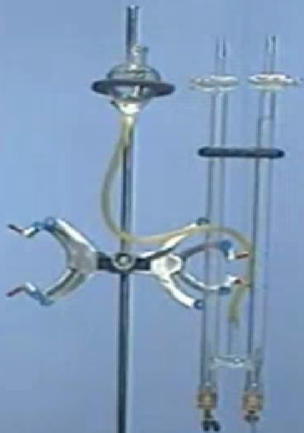
电解水制取氧气和氢气的装置
