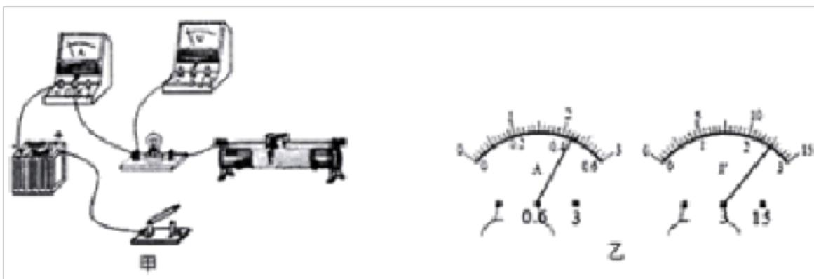
(1) 图甲是未连接好的实验电路，请用笔画线代替导线将它连接完整。（要求：当滑动变阻器滑片向右滑动时，电流表示数变大）
