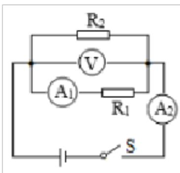
22. (3 分) (2017·丹东模拟) 如图所示， $R_1=20\Omega$ ， $R_2=10\Omega$ ，电源电压保持不变。
