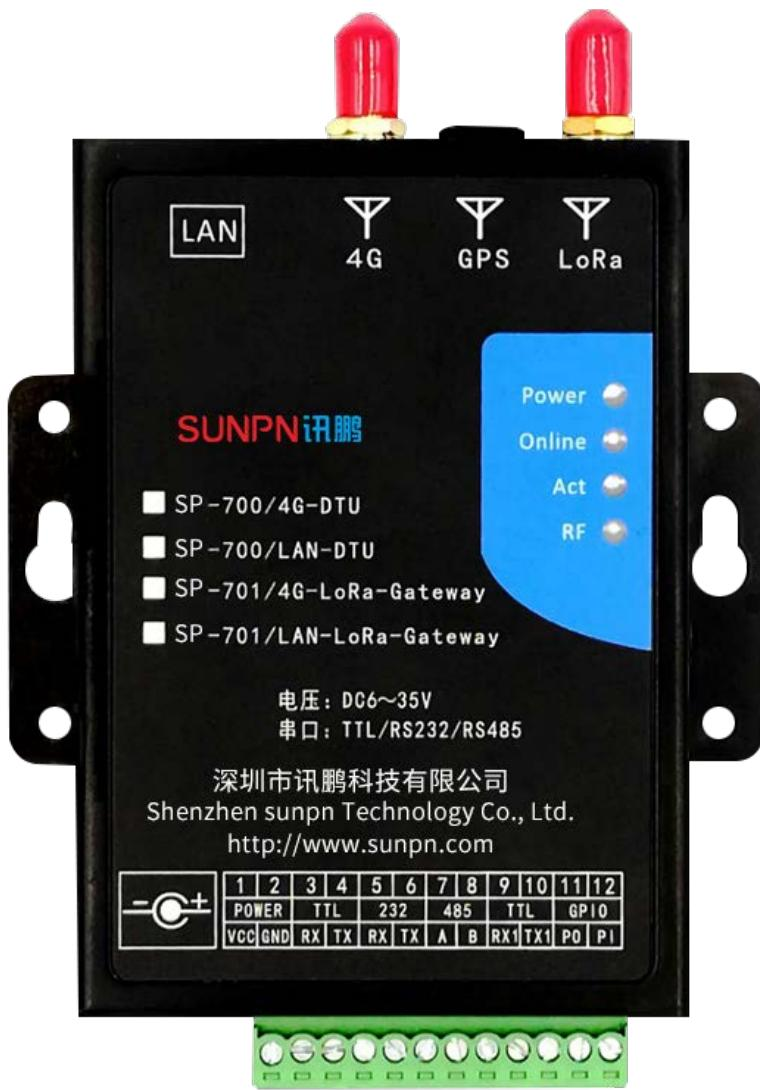
SP-701是一款LoRa转4G/RJ45(网口)的无线数传网关，专门用于将LoRa数据或串口数据转换为IP数据，或将IP数据转换为LoRa数据或串口数据，通过无线通信网络进行传送的无线中继设备。硬件包括控制器单元、通讯模块（4G模组、LoRa模组、以太网模块）、电源管理模块、接口转换电路等主要部件。
