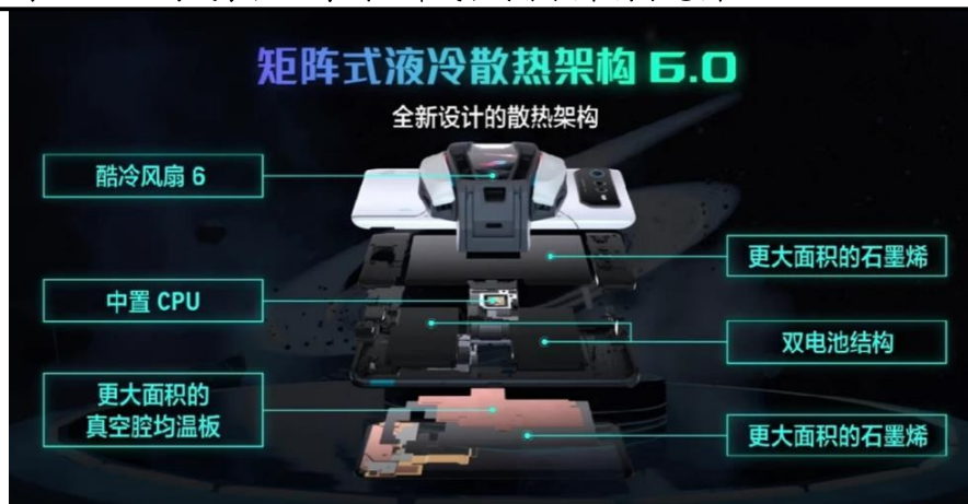
图 23：腾讯 ROG 游戏手机 6 系列矩阵式液冷散热架构示意图
