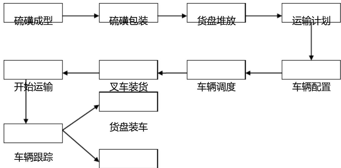
图 3-1 运输计划流程图
