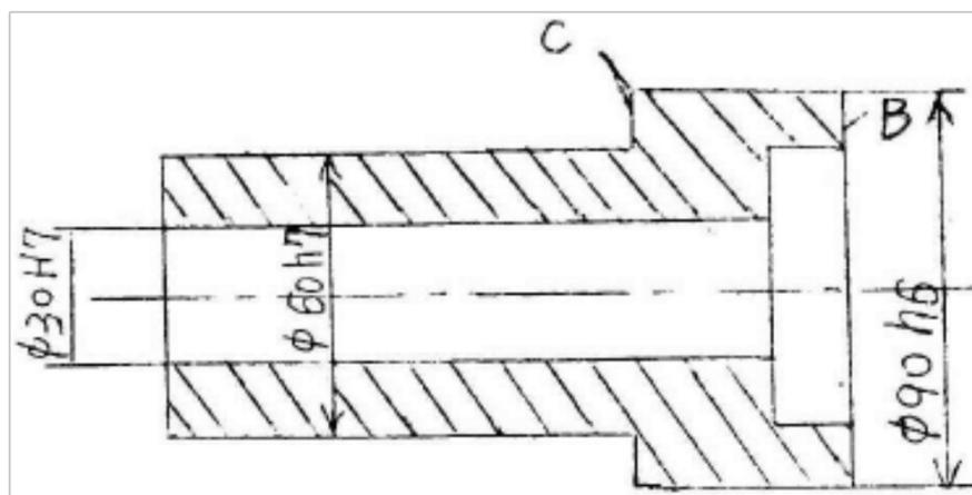
七、说明下列代号的含义；查表确定内、外螺纹大径、中径、小径的极限偏差，并计算极限尺寸。(10分)
