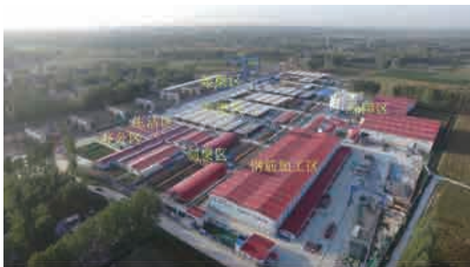
图 5.2.2 箱梁预制场总体平面布置实例图
