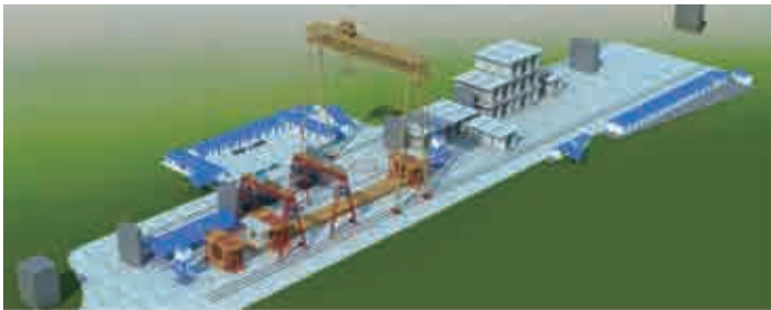
图 5.4.1—2 节段拼装梁预制场总体平面实例图
