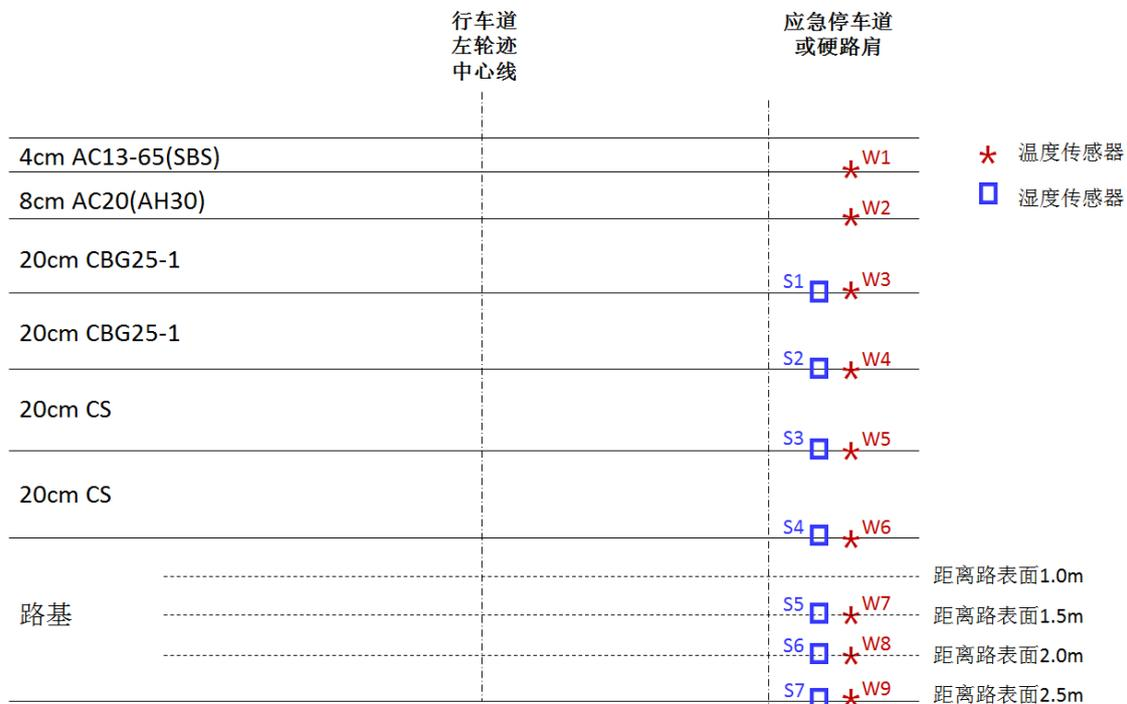
图B.2 一般观测点传感器埋设立面示意
