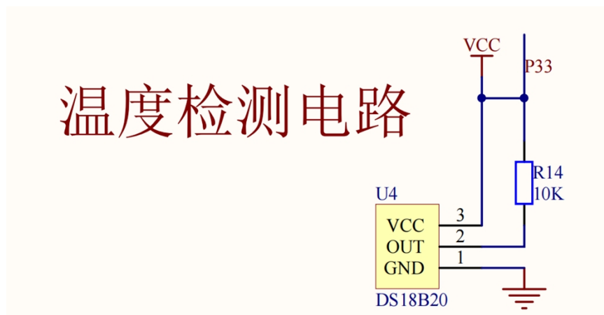
图 3-8 DS18B20 温度检测电路
