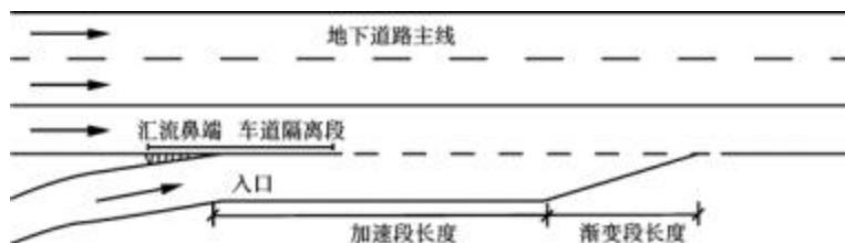
图 4.4.5 城市道路隧道车道隔离段长度
