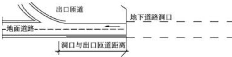
图 4.4.7 城市道路隧道出洞口与邻接地面道路出口匝道距离
