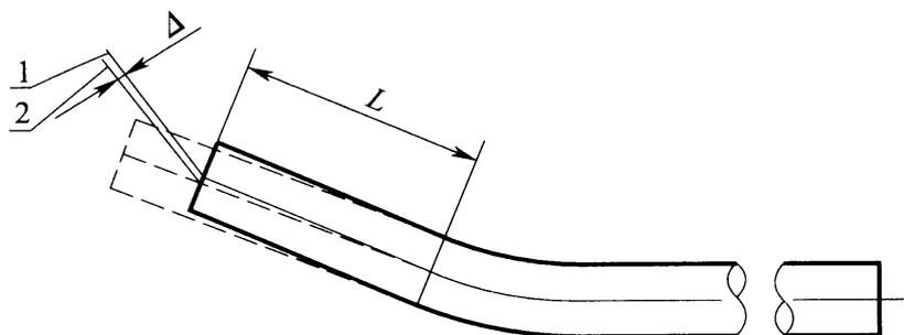
图 4.2.9 弯曲角度及管端中心偏差
