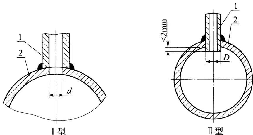
图 5.0.15-1 三通支管与干管的焊接形式
