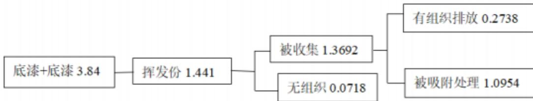
图3 VOCs 物料平衡图 (单位: t/a)
