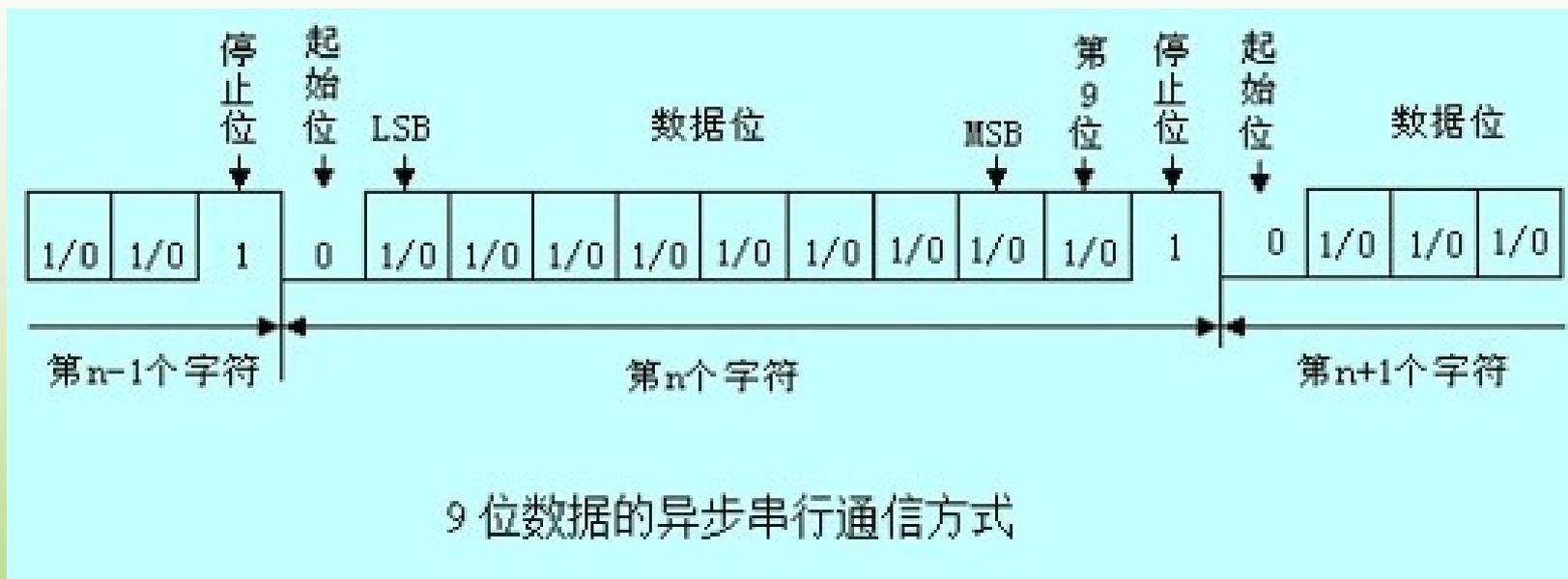
**方式2 与方式3唯一的区别**在于方式2的波特率是固定的，而方式3的波特率与波特率发生器有关
