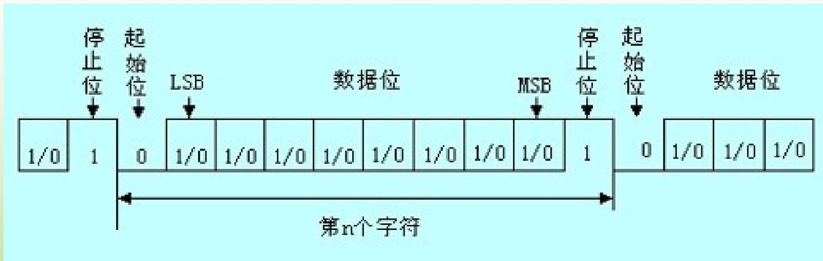
**接受过程:** 在**RI为0**、接受允许控制位**REN被置1**的条件下，CPU处于接受状态。当硬件检测到Rx<sub>D</sub>引脚由高电平变为低电平时，开始接受一帧数据，并同步波特率发生器。
