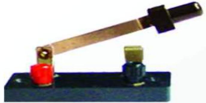
**注意** (1) 连接电路时，开关必须**断开**
