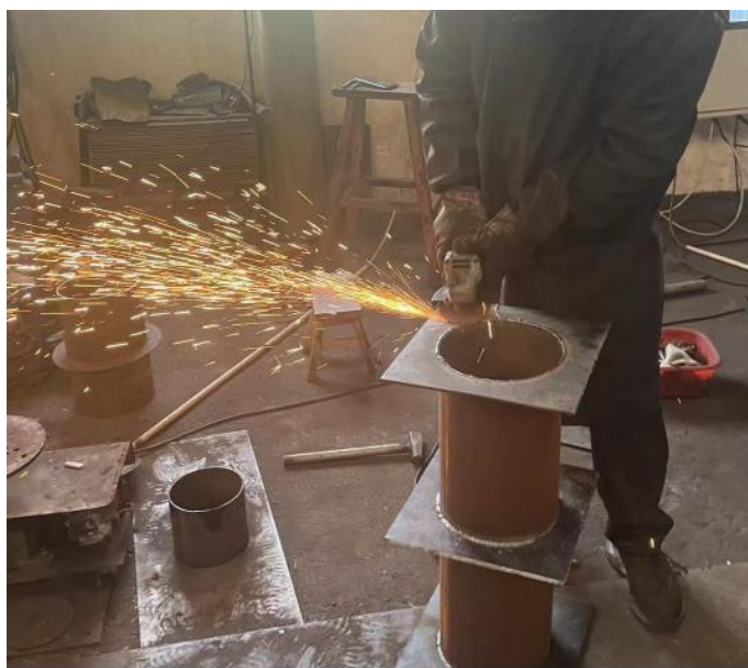
5.2.2-2 钢管套筒加工图
